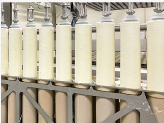
↳ Entformung der Käsestangen und automatisches Einlegen in das Salzbad
