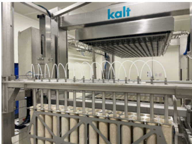
↳ Automatisches Entformen der Laibe nach dem Füllen und Garen
